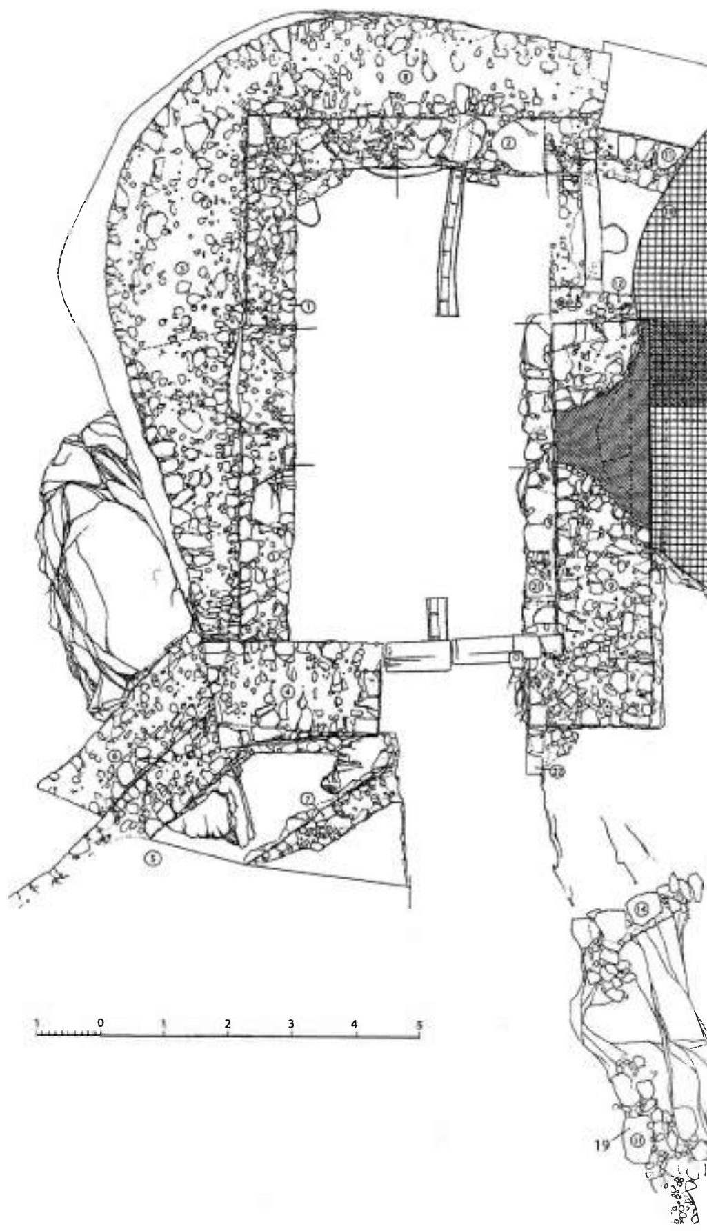
Рис. 182. Обмерный план оборонительных сооружений у главных крепостных ворот Чембало: 1 - строения 20-60-х гг. XV в.; 3 - стена османского периода
